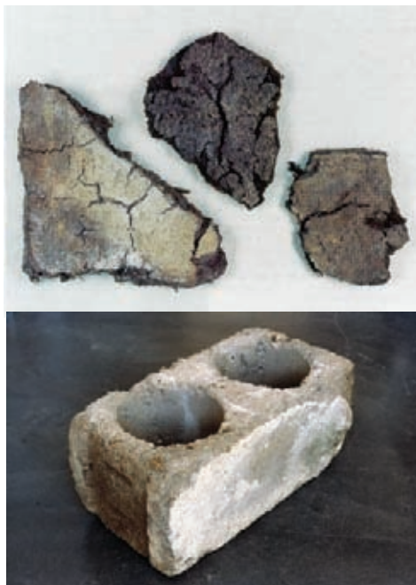
Современные строительные материалы: торфолеум и шлакобетонный камень из района Тёртен в Дессау.
